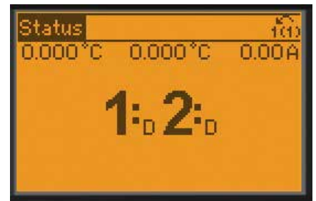
L'état du compresseur est visible sur l'afficheur. D = Pompe raccordée au variateur, O = Pompe à l'arrêt, R = Pompe en Direct secteur, X = Désactivé
